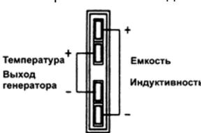
выводы конденсатора имеют достаточную длину для надежного контакта. При измерениях температуры вставьте в разъем термодпару K-типа (NiCrNi), соблюдая полярность подключения. Для функции генератора сигналов вставьте в разъем сигнальный пробник.
