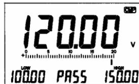
Режим сравнения позволит вам легко оценить попадает ли результат измерения в интервал между двумя заданными величинами. При нахождении результата внутри интервала на среднем дополнительном дисплее появится символ "PASS". Если результат больше верхней границы или меньше нижней на среднем дополнительном дисплее появятся символы "Hi" или "Lo" соответственно.
